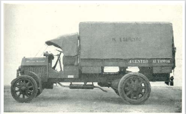
Fig. 72 - Autocarri Isotta-Fraschini 16 A, di tipo pesante, portata Kg 4.000, peso a pieno carico Kg 7.800.
