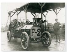
vettura usata in un conflitto bellico, in particolare dal Regio Esercito Italiano nella campagna di Libia. L'autovettura aveva un aspetto sportivo per l'epoca: era dotata di un motore 4 cilindri da 2.612 cm cubici, con la potenza di 20 CV e una velocità massima di 70 Km/h.
