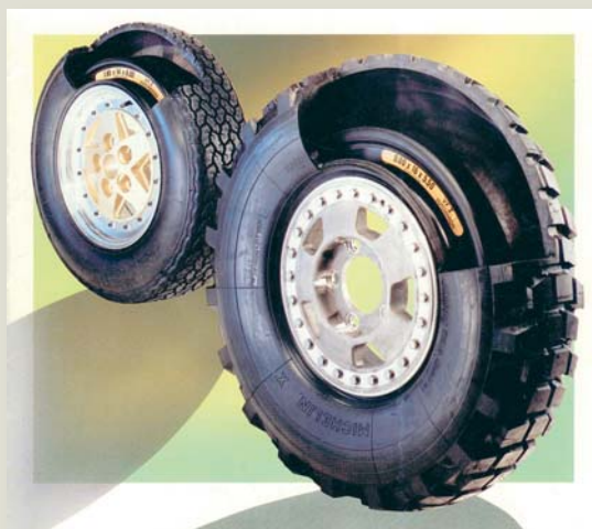
Pneumatici dotati di sistemi di sicurezza VFI Hutchinson
