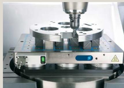
Quelli radiali permettono di usare la massima concentrazione di forza magnetica, specialmente per la lavorazione di pezzi con sagoma anellare, mentre quelli concentrici sono raccomandati per la lavorazione di pezzi massicci e spessi.
