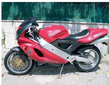
**Bimota SB6 R del 1996.** Motore Suzuki gsx 1100 r 160 cv, 190 kg, 288 chilometri orari. Nel 1996 fu la moto più veloce del mondo. La Bimota - piccola *Factory* Riminese detentrici di ben 2 titoli mondiali battendo i colossi giapponesi - costruiva moto da corsa semi-artigianali, capolavori di "gioielleria" motociclistica, ambite da tutti i collezionisti del mondo.
