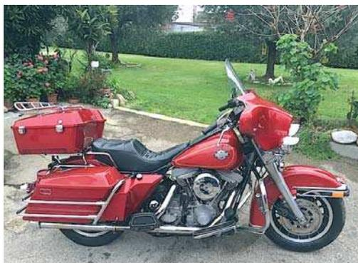
**Harley Davidson Electra Glide 1340 del 1985.** 60 cv, 350 kg, aste e bilancieri, comando valvole idrauliche, trasmissione finale a cinghia. Motocicletta in uso a quasi tutti i reparti di Polizia degli USA.
