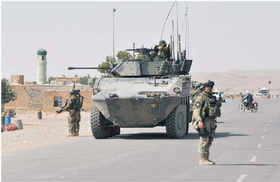
Veicolo blindato medio (VBM) "Freccia": la sola torretta necessita, per il suo funzionamento operativo, di tre software diversi che utilizzano il sistema operativo Windows XP; il mezzo è in grado di relazionarsi, in maniera completamente digitalizzata, con gli altri componenti della Forza NEC, sia orizzontalmente che verticalmente
