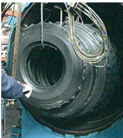
Processo di ricostruzione del pneumatico: selezione, applicazione del nuovo materiale, vulcanizzazione, controllo e finitura
