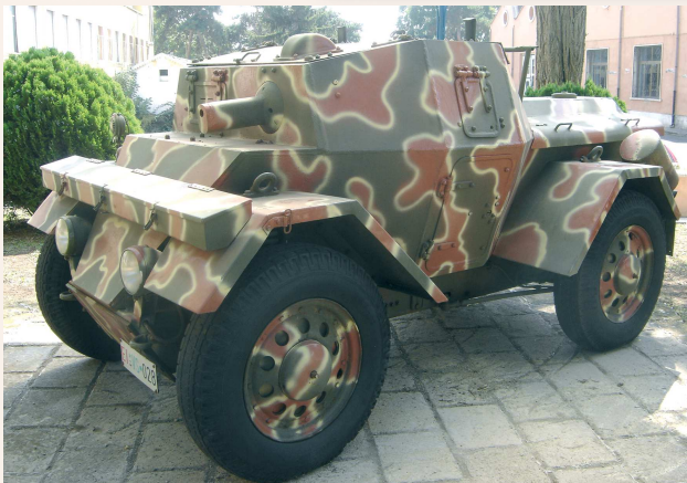
Autoblindo Lancia Astura "Lince", pro- dotta nel corso della seconda guerra mondiale in 263 esemplari; l'armamento era costituito da una mitragliatrice Breda Mod. 38 calibro 8 mm
