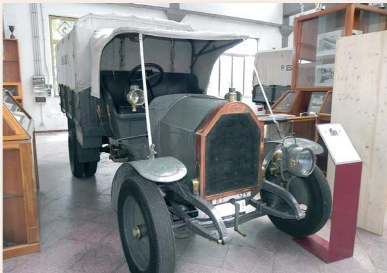
**Autocarro Fiat "15 Ter" del 1911 modello "Libia": esordì nella battaglia di Zanzibar e fu poi a Misurata. Il motore di 4.398 cc da 36 CV consentiva una velocità massima di 40 Km/h ed autonomia di 250 Km**
