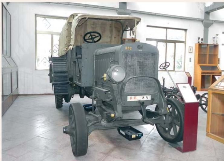
**Trattrice Fiat "20 B" del 1915, un mezzo importantissimo per il trasporto pesante militare: portava un carico di 4 ton. e poteva rimorchiare 25 ton. Usato per il traino di pezzi d'artiglieria, aveva una cilindrata di 6.644 cc e una potenza di 50 CV**
