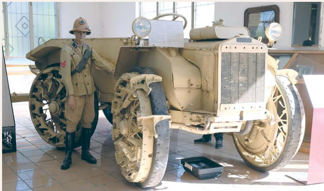
*Trattore Pavesi "P4/100" del 1925. Veicolo avveniristico per l'epoca, a trazione totale, dotato di snodatura completa tra parte anteriore e posteriore. Utilizzata per il traino delle artiglierie, aveva un motore di 4.724 cc e una potenza di 52 CV. Le ruote erano munite di palette ribaltabili per i terreni fangosi*
