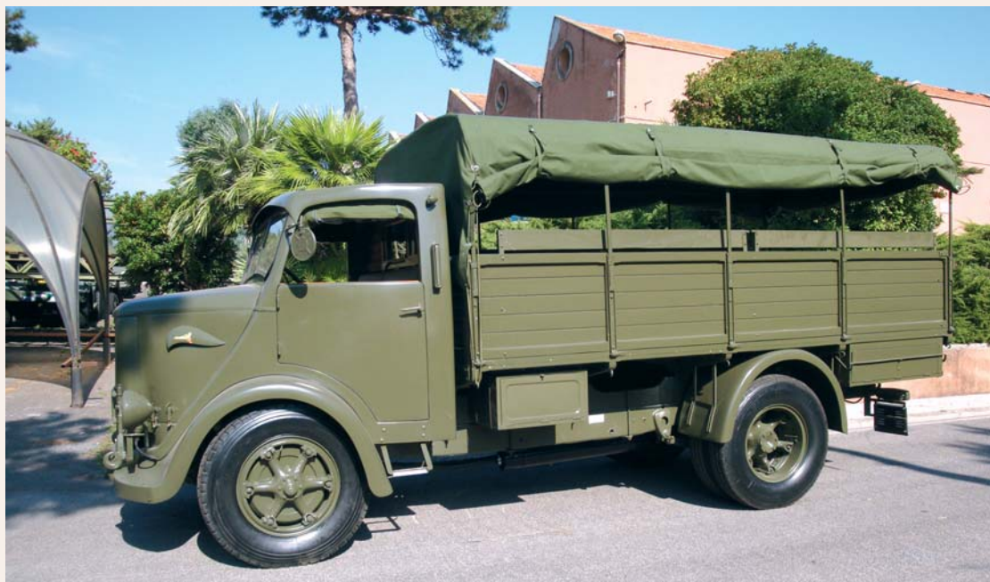
Autocarro Bianchi "Miles" del 1939. Concepito espressamente per gli usi militari, aveva un motore di 4.849 cc e poteva trasportare fino a 3000 kg in materiali o uomini
