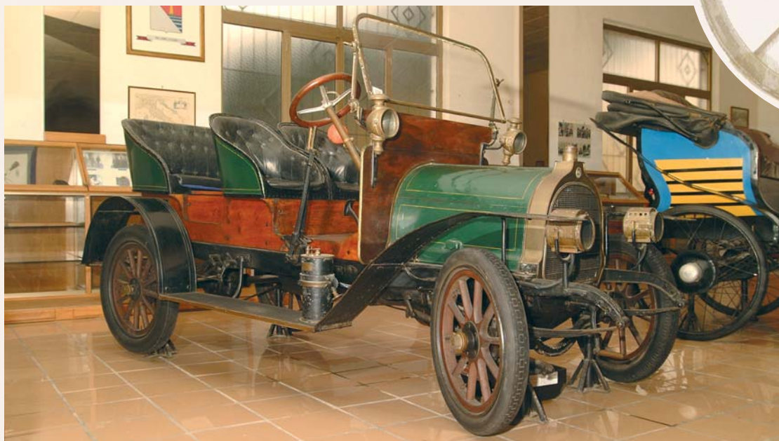
Carro da trasporto a vapore Cugnot del 1769, il primo veicolo “automobile”; sotto: autovettura Zedel 4 posti del 1910. Dotata di motore a 4 cilindri, tre marce e freni sulle sole ruote posteriori, aveva sospensioni a balestra senza ammortizzatori
