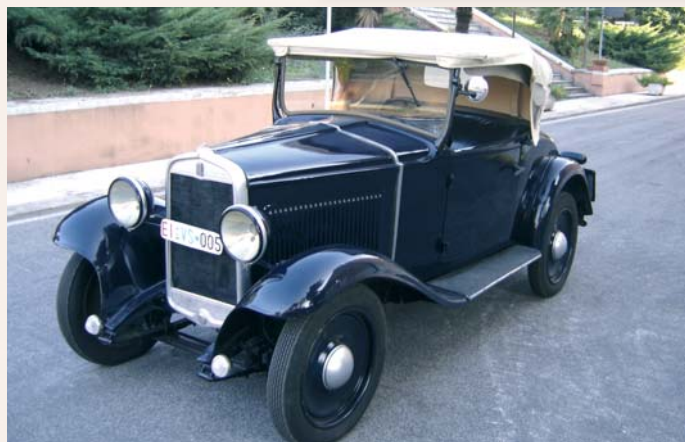
Fiat 508 "Balilla Spider 3 marce" del 1932. La prima 508 montava anteriormente un motore a benzina, a quattro cilindri da 995 cc, capace di sviluppare circa 20 CV. La trazione era posteriore e l'auto montava freni a tamburo su tutte e quattro le ruote. La vettura poteva raggiungere circa 80 km/h
