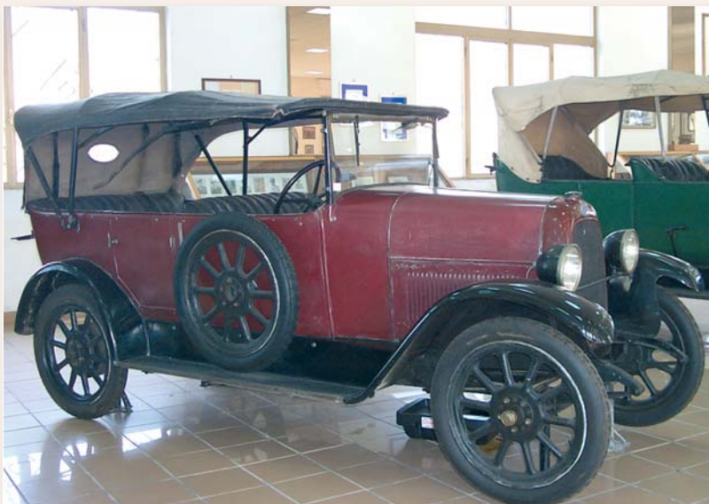
La Itala "61 Torpedo" del 1929. Rappresenta l'ultimo successo della casa automobilistica: nel 1930 la Itala cessò l'attività. La "61 Torpedo" aveva una cilindrata di 1991 cc, motore a 6 cilindri che le conferiva una potenza di 60 CV ed una velocità massima di 100 Km/h
