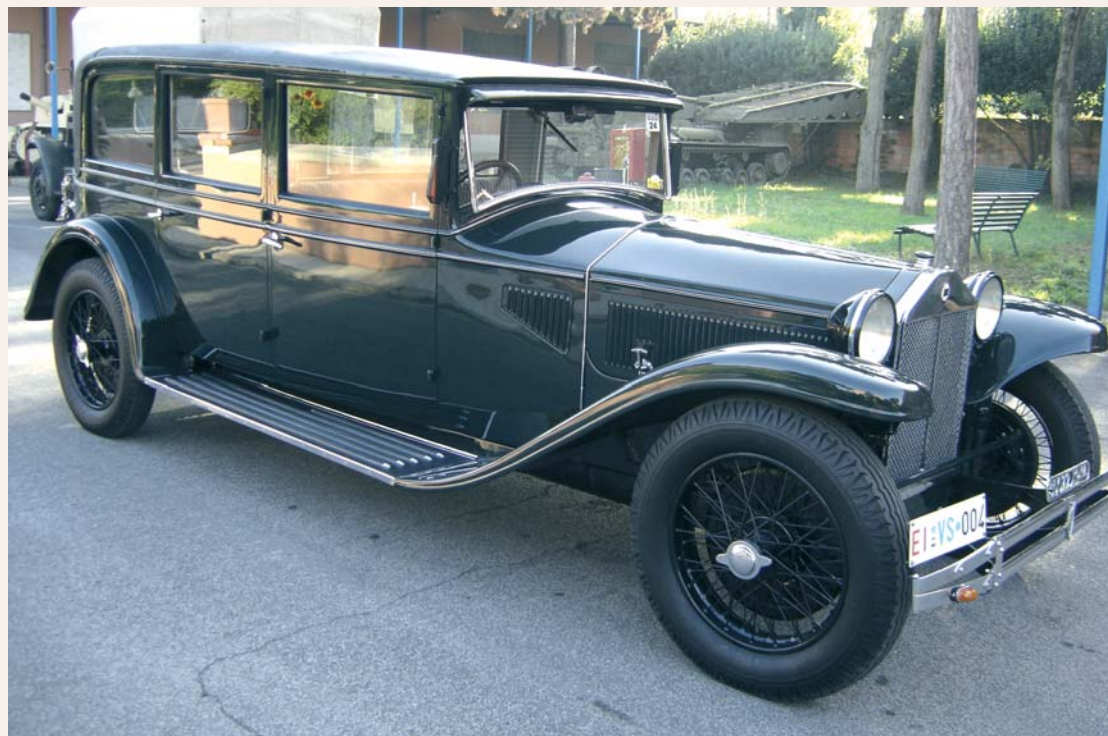
Lancia "Lambda" del 1930. Questa vettura segna un'evoluzione tecnica: per la prima volta fu eliminato il telaio, nella Lambda è la carrozzeria stessa a svolgere la funzione portante. Motore di 2570 cc e potenza di 69 CV; sotto: Alfa Romeo 6C 2500 "Ministeriale" Boneschi del 1947
