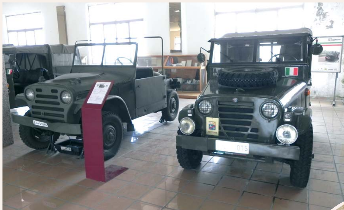
In primo piano l'Alfa Romeo "AR 51 4x4", detta anche 'Alfa Matta'. Autovettura da ricognizione del 1949 con motore anteriore di 1884 cc; accanto la Fiat "AR 51 4x4" del 1951: un mezzo da considerarsi storico in quanto adottato da tutte le forze armate e rimasta in servizio fino alla fine degli anni '80
