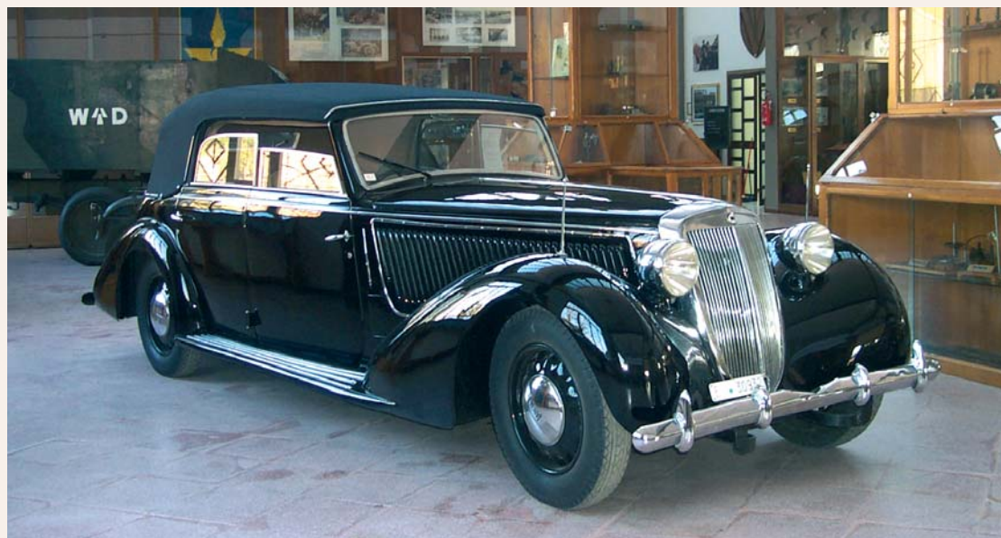
Lancia "Astura" del 1936. Fuoriserie a quattro posti con carrozzeria cabriolet, montava un motore da 2972 cc a 8 cilindri e velocità massima di 130 Km/h; sotto: Alfa Romeo "6 C 2500 Turismo" del 1939. Berlina a cinque posti con una potenza di 87 CV e velocità massima di 143 Km/h
