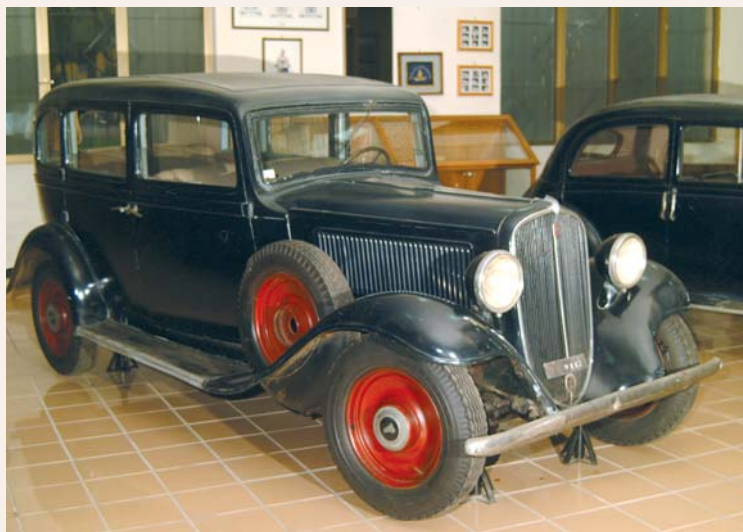
La Itala "61 Torpedo" del 1929. Rappresenta l'ultimo successo della casa automobilistica: nel 1930 la Itala cessò l'attività. La "61 Torpedo" aveva una cilindrata di 1991 cc, motore a 6 cilindri che le conferiva una potenza di 60 CV ed una velocità massima di 100 Km/h
