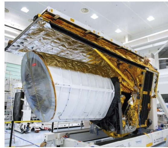
Il telescopio Euclid è stato costruito tra Torino e Tolosa; modello termico e strutturale del telescopio ESA Euclid usato per i test pre-lancio; il volo del telescopio spaziale Euclid
