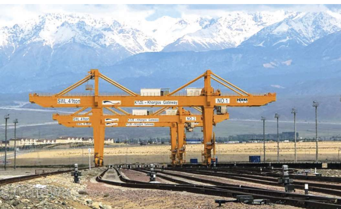
A Khorgos (frontiera con il Kazakistan) avviene il trasbordo dei carichi per via della differenza di scartamento con la Russia
